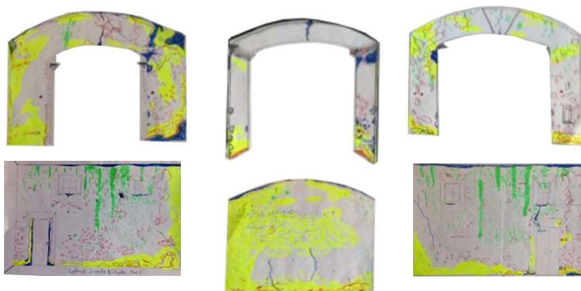
Imagem 07 - Mapeamento inicial das patologias
