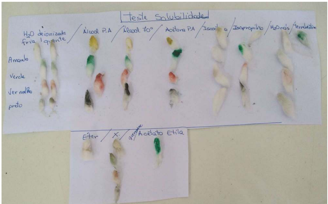
Imagem 27 - Teste de solubilidade parede lateral esquerda da Capela – Mor.
